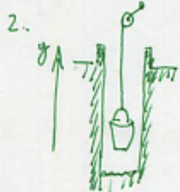
$$W = F \cdot \Delta y = mg \cdot \Delta y = 20.0 \text{ kg} \cdot 9.80 \frac{\text{m}}{\text{s}^2} \cdot \Delta y \quad (6.5)$$
